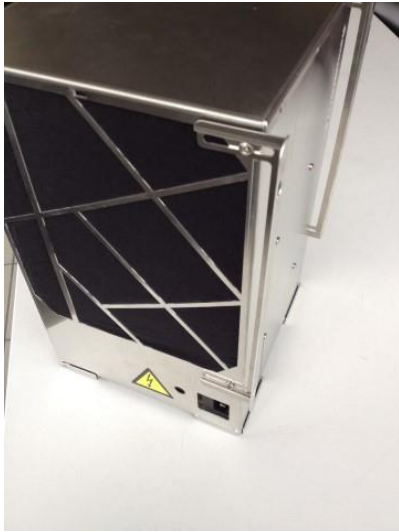
Afb. 5: M4 bevestiging van de montagebeugel
