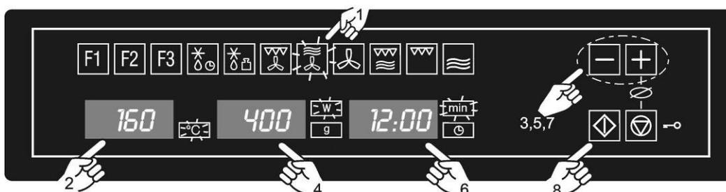
1. Druk op de toets van de **Magnetron + Hete lucht**-functie. De functietoets licht op.
