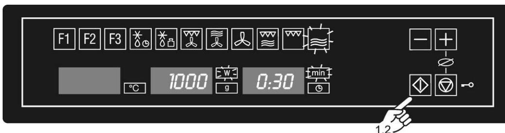
1. Druk op de **Start**-toets. De oven begint gedurende 30 seconden op het maximumvermogen in de magnetron-functie te werken.
