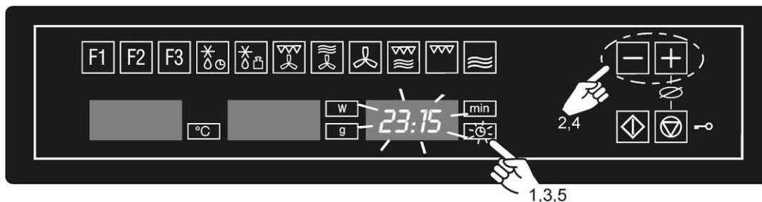
Après une coupure d'électricité, ou si le four a été rebranché, l'horloge clignote pour indiquer que l'indication de l'heure n'est pas correcte. Pour régler l'horloge, procédez de la façon suivante :
