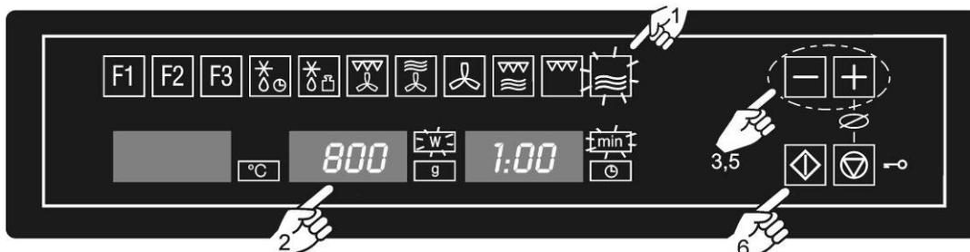
1. Druk op de toets van de **Magnetron**functie. De functietoets licht op.
